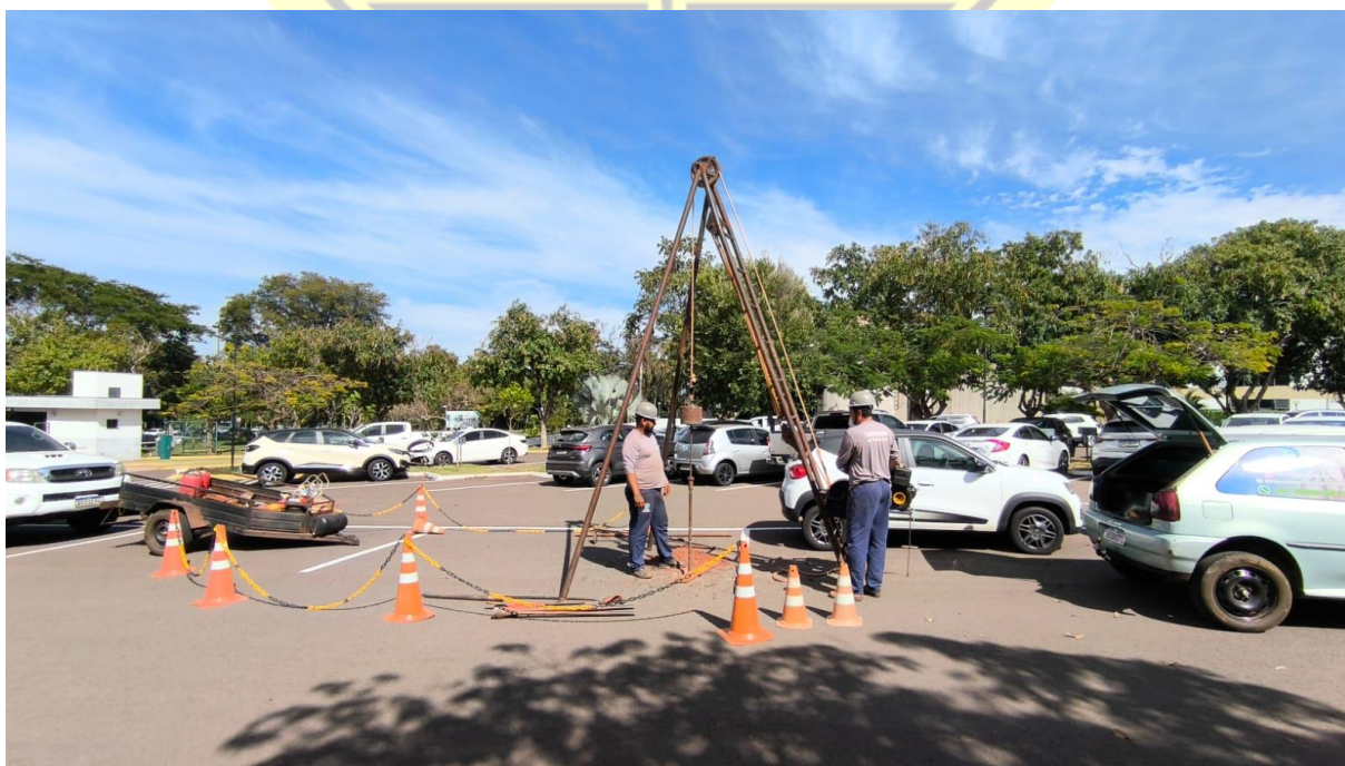
Figura 59 – Execução de sondagem SPT-11
